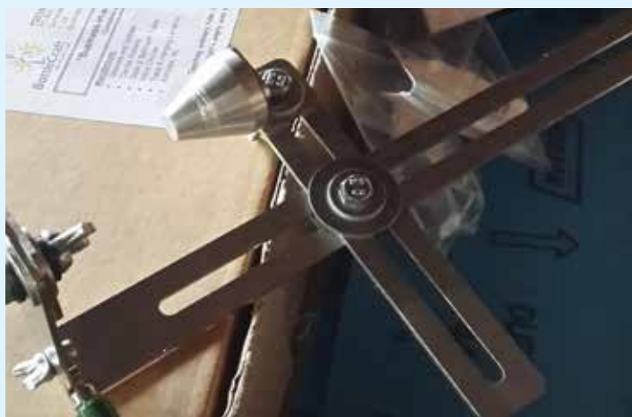
Kits pour la découpe artisanale de verre qui sont utilisés avec les déchets de verre des établissements touristiques dans la zone de TBT à Mozambique (Photo: Projet COAST)
