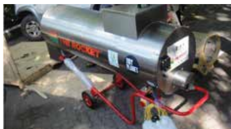
Rocket composter installé au Turtle Bay Beach Club, Site de Démonstration de Watamu au Kenya (Photo: Projet COAST)
